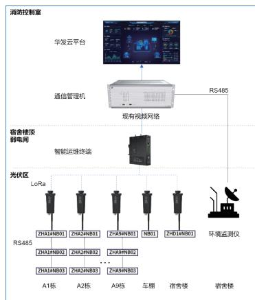
基于LoRa组网，无需铺设通信线缆
