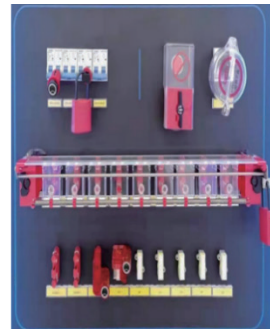
二次设备开关柜闭锁
