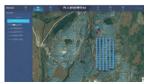
采集全站光伏板全景图，规划巡检航线
