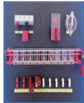
二次设备开关柜闭锁
