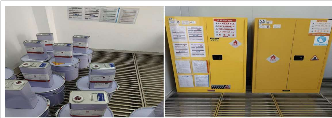
正常化学品存放，易燃易爆存放于防爆柜内
