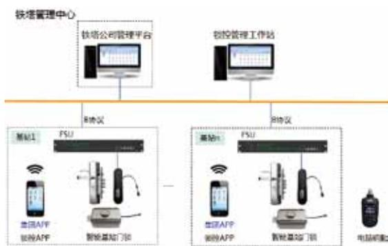
JOYO-E31基站门锁安全管控系统由锁控管理工作站、锁控管理软件、电脑钥匙、锁控APP、智能基站门锁等组成。配合铁塔公司现有管理平台及基站FSU（智能动环监控单元）实现对基站门锁的管理。
