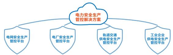
该解决方案覆盖电网发电、输电、变电、配电、用电的各个环节,以微机防误、两票管理、地线管理、二次防误、视频智能分析、检修闭锁、带电强制闭锁等技术为基础,用技术手段确保管理制度落到实处,为电力企业安全生产提供全过程管控技术措施,并将安全管控技术拓展至轨道交通供电及工业企业供电领域,保障运行操作安全、设备资产安全和供电生产安全,减少和降低电力安全生产事故。
