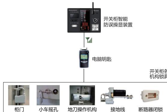
GSN2C\_E 高压带电显示闭锁装置除具有常规高压带电显示功能外，还具有与防误闭锁系统电脑钥匙相匹配的防误接口，高压带电显示闭锁装置利用微机防误接口可向电脑钥匙提供设备带电情况，电脑钥匙收到带电信息后，判断是否继续操作，从而实现带电强制闭锁的目的。
