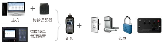
图1 配网户外环网柜智能安全锁控系统示意图
