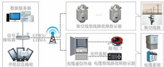
故障定位系统结构图
