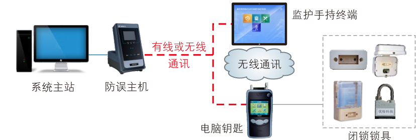
JOYO-CZ操作票危险点分析及操作监护系统结构图
