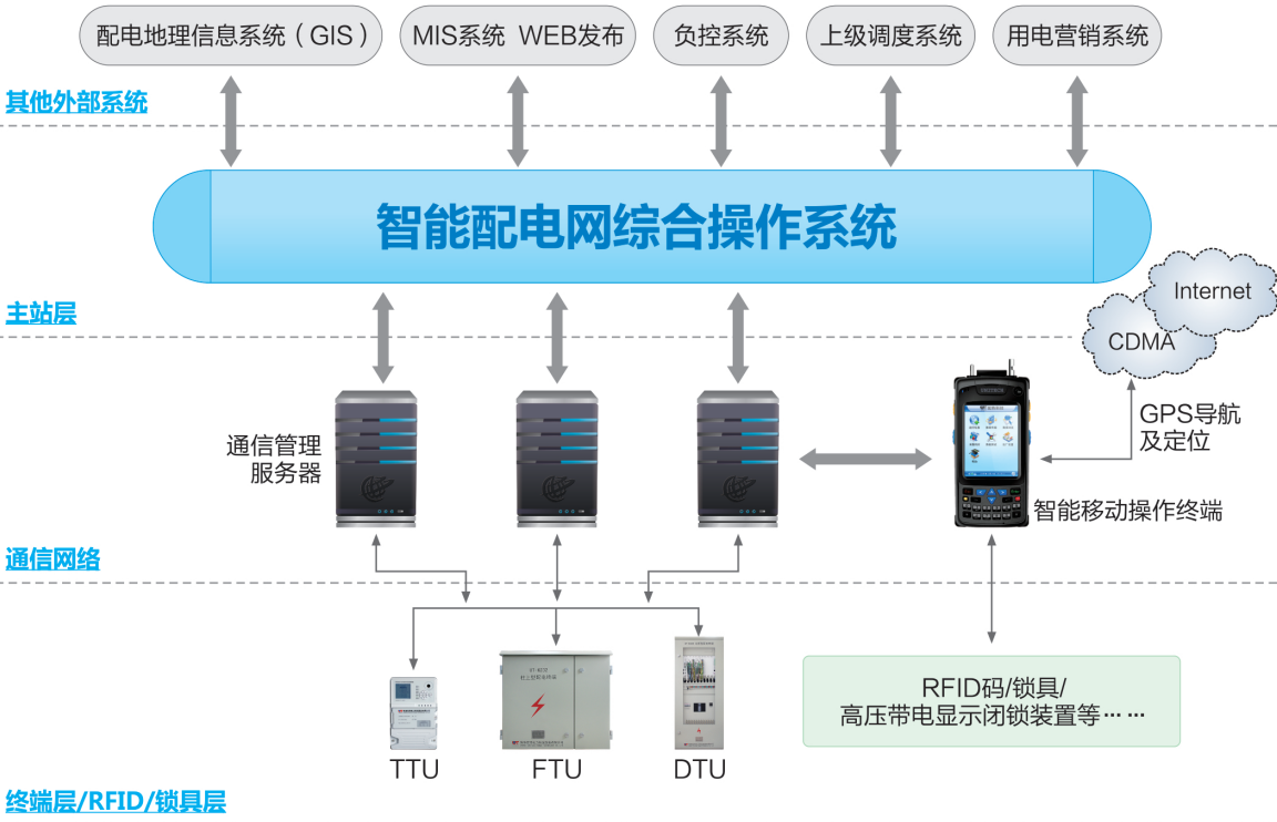
智能配电网操作系统架构图
