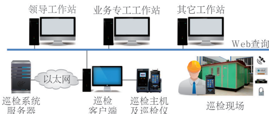
JOYO-X配网设备巡检系统结构图
