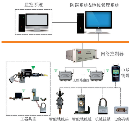
图2 无线地线桩管理地线方案结构图
