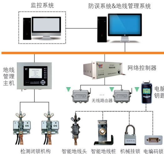
图1 实时化地线管理解决方案结构图
