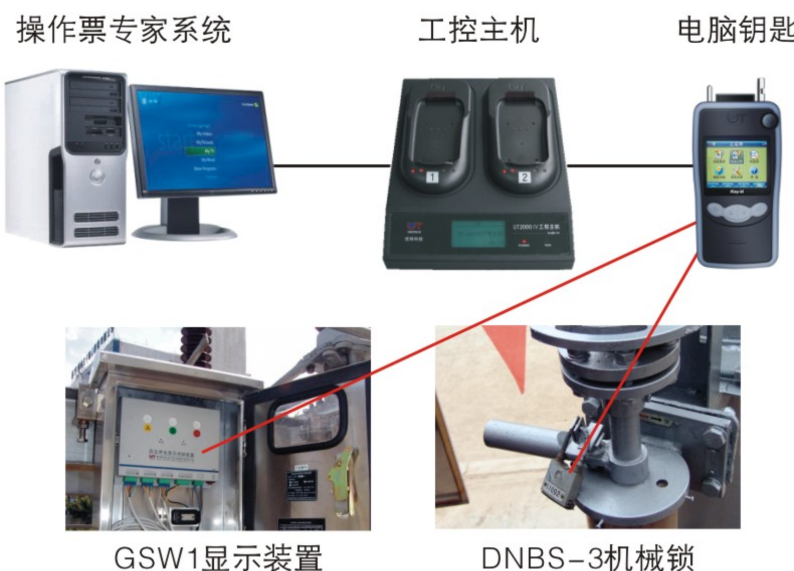
图5 该变电站应用系统组成图
