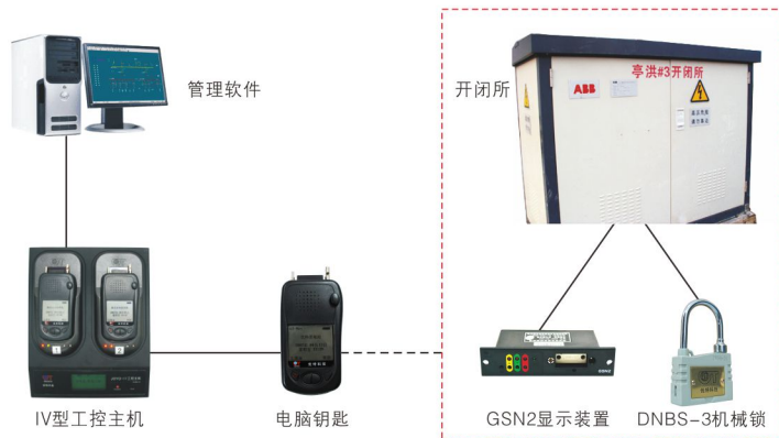
图2 GSN2与五防配合使用系统结构图
