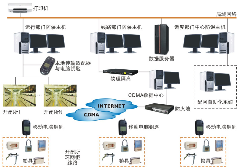
图1：调度配网综合防误操作系统图
